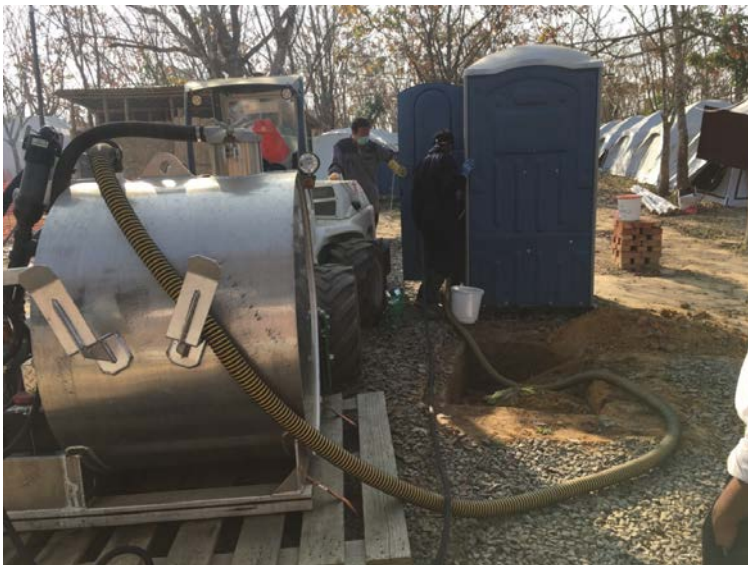
バキューム装置でコンテナ型トイレの糞便を吸引しているところ
