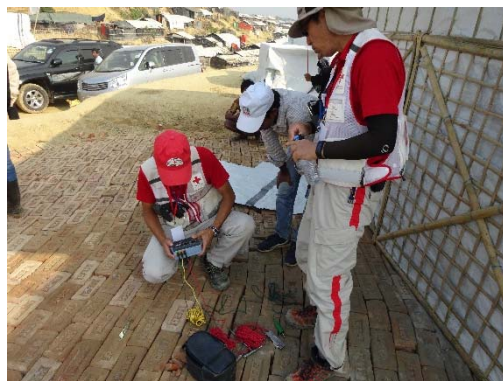
接地抵抗計で地面の抵抗を測定
