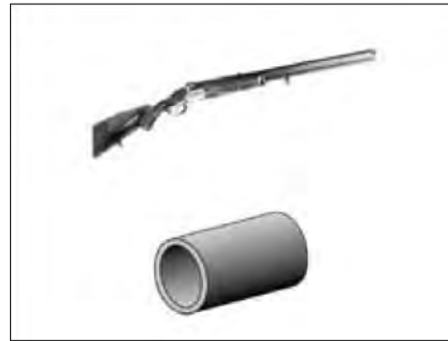
図 3.10 銃身の内側が平滑な典型的な狩猟用ショットガン
