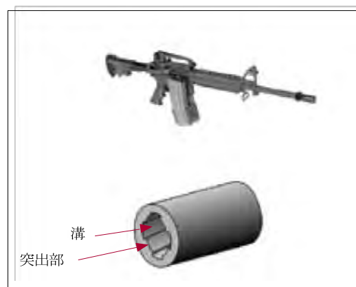
図 3.9 ライフルの銃身の断面: 5.56×45 mm M-16 A4 軍用ライフル 溝と突出部(溝と溝との間の出っ張り)が示されている。
