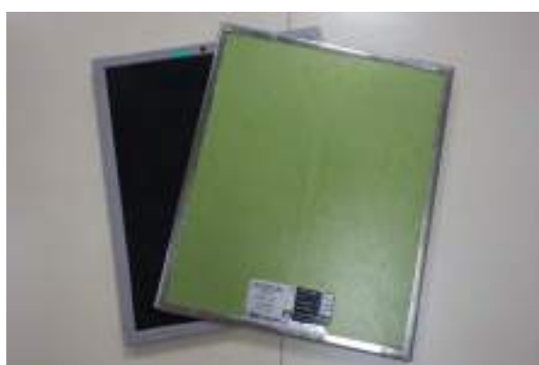
グリッド (手前) とカセット (後方) グリッドは中央に線が引いてある方が表側。 表側を X 線に向けるようにセットする。
